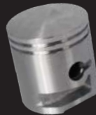
Pistone con doppia fascia elastica, fuso in conchiglia, che migliora il raffreddamento.
