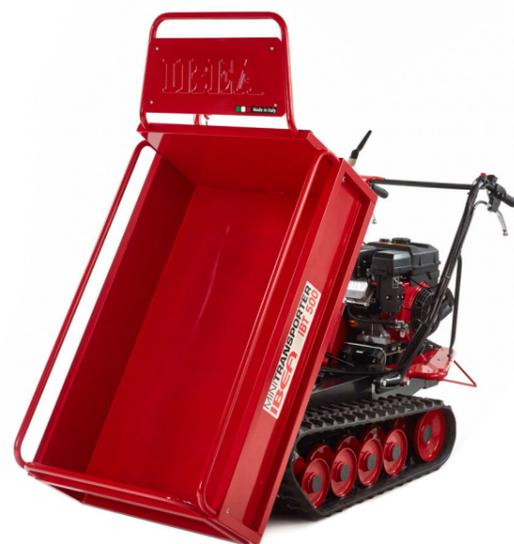
Il cambio a 5 rapporti (3 marce avanti e 2 retro) è il cuore di ogni Minitransporter. E' sovradimensionato per poter gestire nella massima sicurezza le enormi coppie generate dal motore. Grazie all'efficiente demoltiplica, i Minitransporter hanno la capacità di muoversi in ogni situazione e sotto ogni carico.
