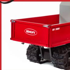
Il Minitransporter IBT-3000 è il più piccolo della gamma con una portata massima di 300 Kg. La versione 3500 garantisce una portata massima di 350 Kg e grazie al rullo basculante permette di effettuare il trasporto di materiali in qualsiasi condizione di terreno.
