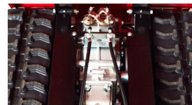
L'installazione del cambio nella parte anteriore del telaio, garantisce il bilanciamento della macchina sia a vuoto che a pieno carico e facilita il movimento anche su terreni particolarmente sconnessi.
